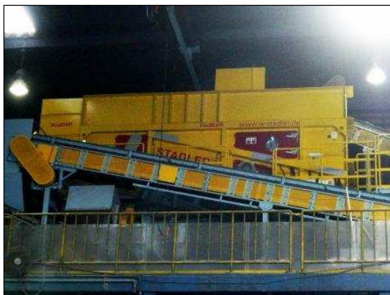
バリスティックセパレーター（多種選別機・2Dと3D）
